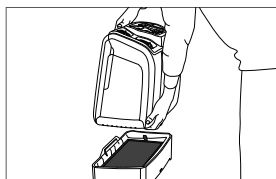
Uchopte rukojeť v zadní části přístroje AbsFur a oddělte jej od modulu AP.
